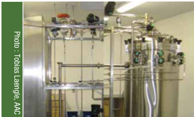
Figure 4. Installations commerciales de fermentation microbienne à des fins agricoles où la souche ACM 941 du Clonostachys rosea a été produite en quantité suffisante pour des essais au champ à grande échelle.
